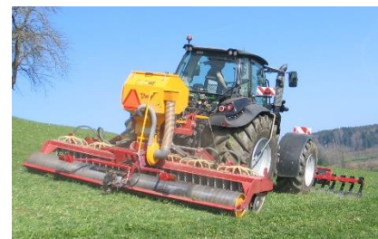
Die Direktsaat ist weniger trockenheitsempfindlich, geeignet z.B. für südexponierte Parzellen. Die engen Säscharen von Vredo (7.5cm) eignen sich auch für Weiden.
