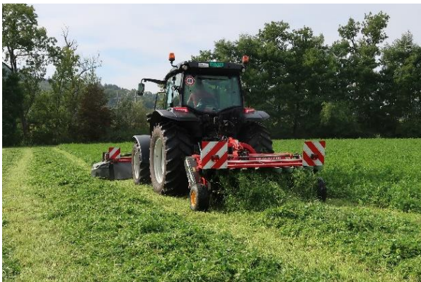
Abb. 1: Ein hoher Schnitt von Herbstgras vermindert Fehlgärungen beim Silieren. Mit dem Aufbereiter, der Breitablage und einem Kreiseldurchgang können die erwünschten 30% TS oder noch besser 35% TS erreicht werden.
