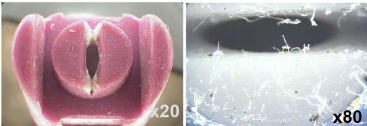
Die Düsen bitte nicht mit einem Draht, Schraubenzieher, Messer oder Schleifpapier reinigen. Reinigen Sie die Düse durch Einweichen in einem geeigneten Reiniger, mit Bürste und Luft oder einem Ultraschallbad. Weitere Infos siehe [Lechler](#).
